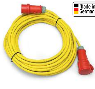
Удлинительный кабель 400 В, 16 А, H07RN-F 5G2,5
