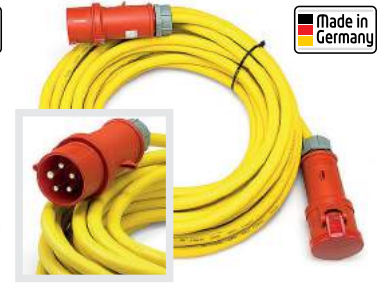
Удлинительный кабель 400 В, 32 А, H07RN-F 5G6
